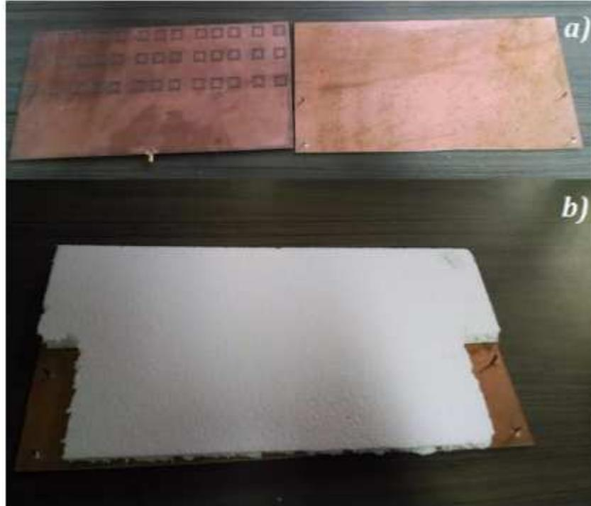
**Figura 2.18.** (a) Antena con el reflector colocado. (b) Lámina de poliestireno para dar soporte mecánico entre el plano de tierra y el reflector [20].
