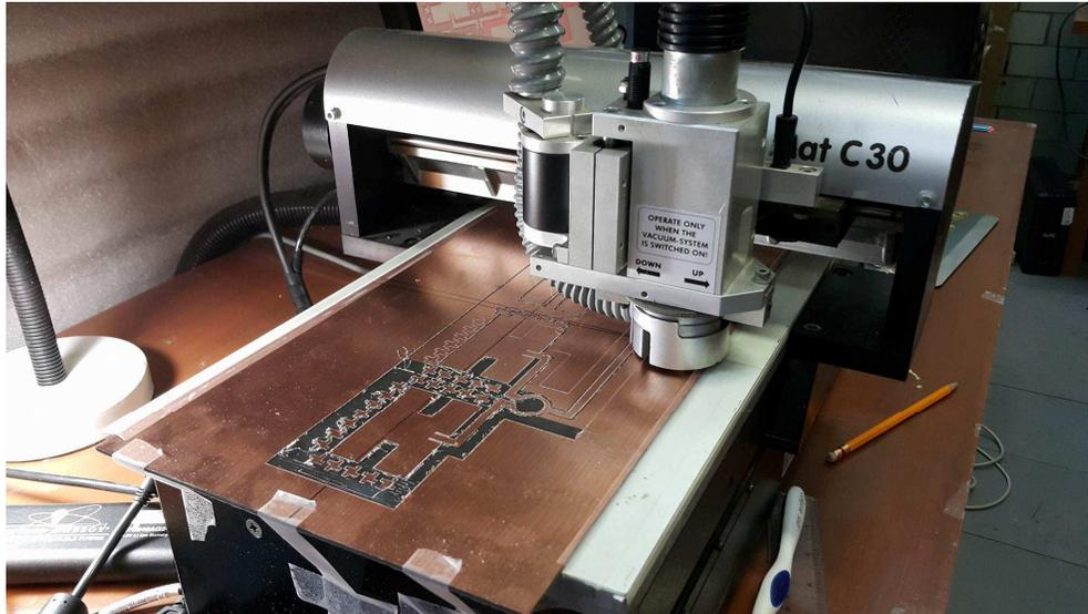
**Figura 5.5.** Plotter LPKF ProtoMat C30/S durante la construcción del arreglo de antenas diseñado.
