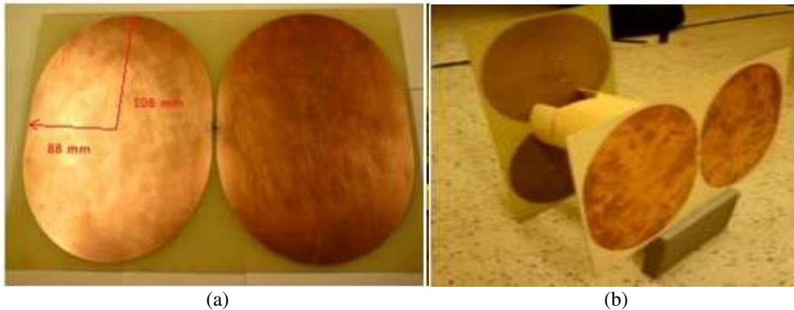
**Figura 2.14.** Antena propuesta. (a) Una sola antena. (b) Arreglo ortogonal de antenas [18].
