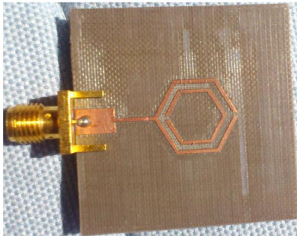
**Figura 2.16.** Antena metamaterial con SRR hexagonales [19].
